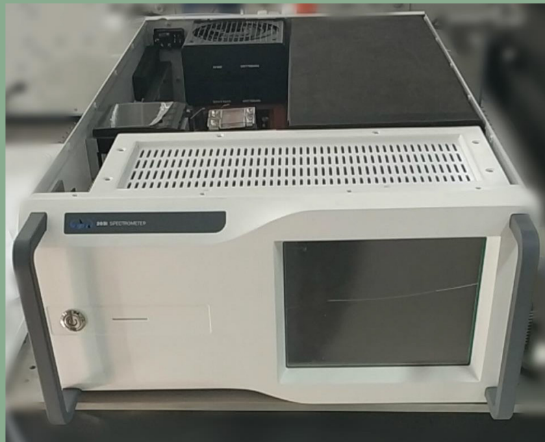
图 2-1 中国计量科学院设计的光腔衰荡光谱仪设备
