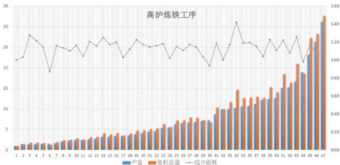
图2-21 高炉炼铁工艺能耗及能效（数据均经归一化处理，以下相同）
